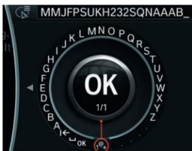
Le code d'activation étant aussi bien composé de lettres que de chiffres, l'utilisateur doit passer manuellement des lettres aux chiffres **dans le système iDrive**, en se servant de la commutation vers les caractères spéciaux **1@+.**
