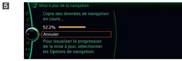
Les données ne sont actualisées que **pendant le trajet**. Ce processus se déroule en arrière-plan. Les fonctions de base de votre système de navigation sont conservées. Veuillez laisser la clé USB branchée **jusqu'à la fin du processus de mise à jour**.
