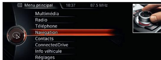
Tournez l'**iDrive Controller**, choisissez **Navigation** dans le menu principal et appuyez sur l'iDrive Controller une fois vers le bas. Appuyez sur le bouton d'entrée direct **Options**.
