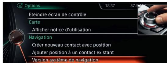
Tournez l'**iDrive Controller**: dans les options, choisissez **Version système de navigation** et appuyez sur l'iDrive Controller une fois vers le bas.
