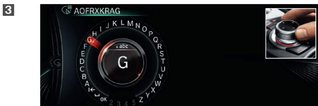
Entrez le **code d'activation** à 20 caractères en vous servant de l'iDrive Controller. Les chiffres **0 et 1** ne font **pas partie** du code d'activation afin d'éviter les méprises avec les lettres **O et I**.
