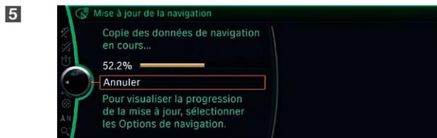
Les données ne sont actualisées que **pendant le trajet**. Ce processus se déroule en arrière-plan. Les fonctions de base de votre système de navigation sont conservées. Veuillez laisser la clé USB branchée **jusqu'à la fin du processus de mise à jour**.
