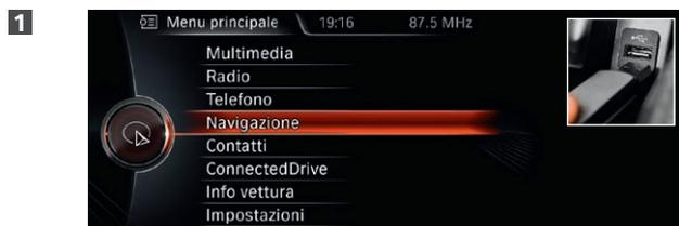
Collegate la **chiavetta USB da 32 GB** al sistema. Nel sistema di navigazione la schermata passa automaticamente alla modalità di aggiornamento.
