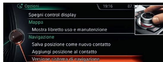
Ruotate l'**iDrive Controller** nel menu **Opzioni** fino a raggiungere la voce **Versione sistema di navigazione** e premetelo una volta verso il basso.
