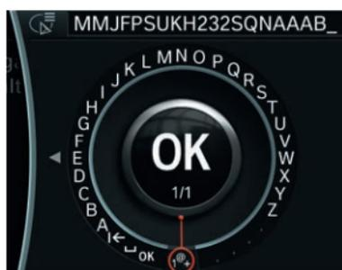
Siccome il codice di abilitazione si compone sia di lettere che di numeri, **nel sistema iDrive** l'utente deve passare manualmente dalle lettere ai numeri selezionando **1@+**.
