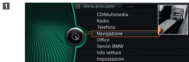
Collegate la **chiavetta USB da 8 GB** al sistema. Nel sistema di navigazione la schermata passa automaticamente alla modalità di aggiornamento.
