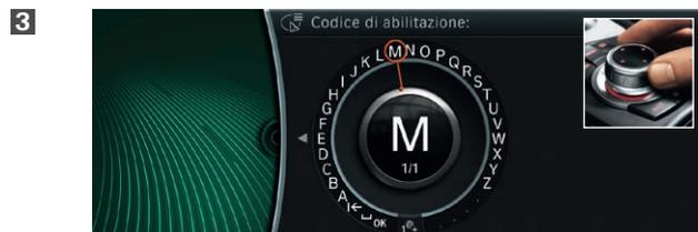
Immettete il **codice di abilitazione** di 20 caratteri tramite l'iDrive Controller. I numeri **0 e 1 non sono contenuti** nel codice di abilitazione per evitare di confonderli con le lettere **0 e l**.
