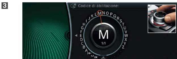
Immettete il **codice di abilitazione** di 20 caratteri tramite l'iDrive Controller. I numeri **0 e 1 non sono contenuti** nel codice di abilitazione per evitare di confonderli con le lettere **0 e 1**.
