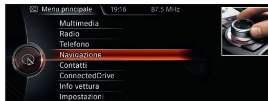
All'interno del menu principale, ruotate l'**iDrive Controller** fino a raggiungere la voce **Navigazione** e premetelo una volta verso il basso. Premete il tasto di selezione rapida **Opzioni**.
